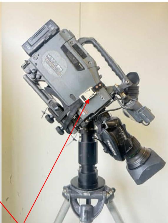
※カメラはL型金具に備え付けてある落下防止バンドで固定します。
